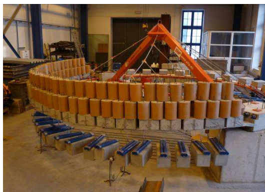
Obr. 8 Mezní zatěžovací zkouška - visutá část
